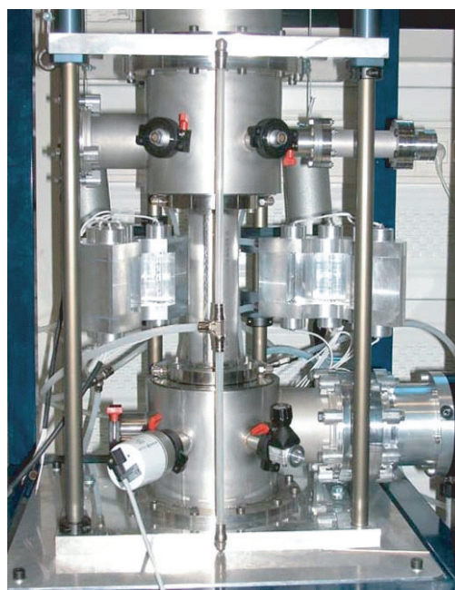
Fig. 4. Tribomètre environnemental réalisé pour cette étude
