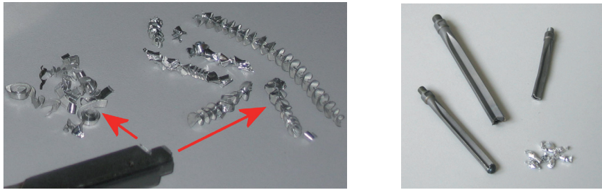
Fig. 1. Copeaux continus et outils endommagés.
