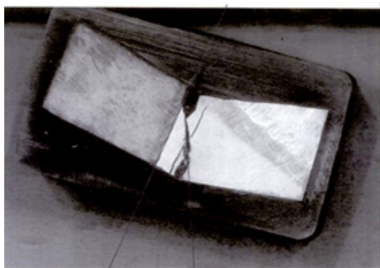
Fig. 4. Déviation de fissure lors de la fissuration par fatigue d'une éprouvette C(T).
